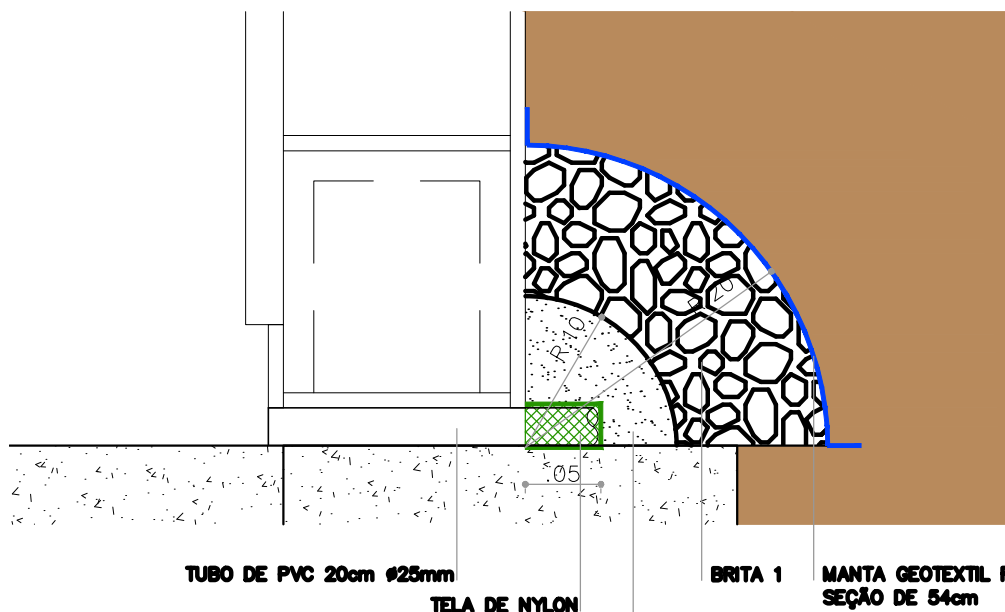
DETALHE DRENO ESCALA 1:5
